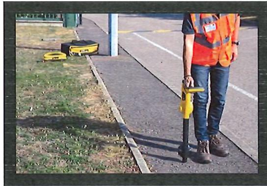
Le contrôleur hydrant sera équipé d'un détecteur de métaux professionnel et de matériel de radiodétection spécialement calibré pour la détection de plaque d'égouts ou de bouches à clé. Ce matériel répondant à la norme d'étanchéité IP67 afin de garantir une utilisation en toute circonstance à notre contrôleur.
